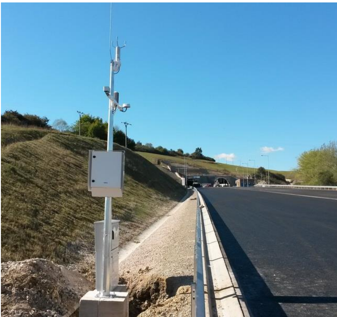
Obr. 7 Systém AWOS v správe Národnej diaľničnej spoločnosti [zdroj: http://www.spinnet.sk/index.php?page=meteo/road/rws200 ]
