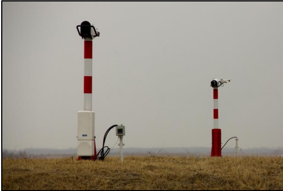
Obrázok 2 Transmissiometer, prístroj na meranie dráhovej dohľadnosti
