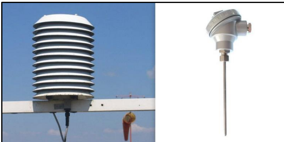
Obrázok 4 Digitálny teplomer PT100 so senzorom vlhkosti vzduchu vľavo s radiačným krytom, vpravo bez krytu
